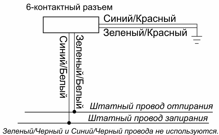
Схема 1. 3-проводная система с отрицательной полярностью (большинство японских автомобилей)
